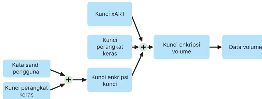
Di Mac dengan Apple silicon dan Mac dengan keping T2, semua penanganan kunci FileVault berlangsung di Secure Enclave; kunci enkripsi tidak pernah terpapar secara langsung ke CPU Intel. Semua volume APFS dibuat dengan kunci enkripsi volume secara default. Konten volume dan metadata dienkripsi dengan kunci enkripsi volume ini, yang dibungkus dengan kunci enkripsi utama (KEK). KEK dilindungi oleh kombinasi kata sandi pengguna dan UID perangkat keras saat FileVault dinyalakan.
