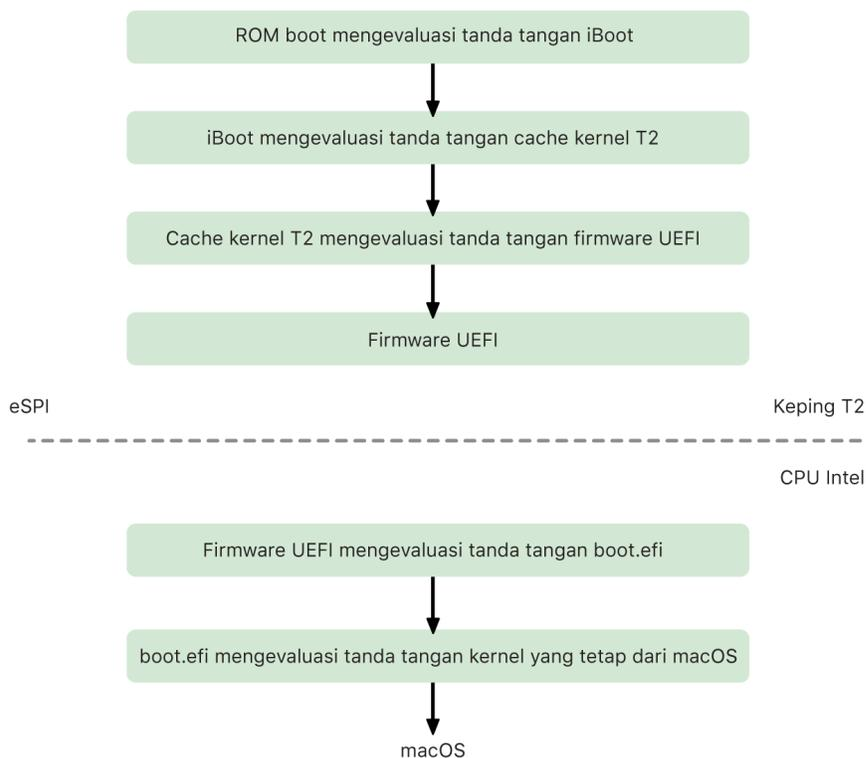
Setelah verifikasi, image firmware EFI dipetakan ke bagian memori keping T2. Memori ini dibuat tersedia bagi CPU Intel melalui Antarmuka Periferal Serial yang ditingkatkan (eSPI). Saat melakukan boot untuk pertama kalinya, CPU Intel mengambil firmware EFI melalui eSPI dari salinan firmware yang telah diperiksa integritasnya dan dipetakan ke memori, yang terdapat di keping T2.
